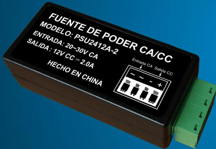
PSU2412A-2 es un convertidor de voltaje regulado de 24V AC a 12V cc que es capaz de alimentar cámaras IR a largo alcance, cámaras PTZ u otros dispositivos que requieran 12 V CC cuando solo estén disponibles 24 V CA. El tamaño pequeño de este convertidor le permite caber dentro de la mayoría de las carcasas de cámara típicas, aun así tiene la capacidad de salida de corriente más grande que hemos visto: 2.0 A
