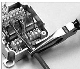
Con unos alicates o un destornillador, según sea necesario, asegure los cables utilizando cualquiera de los varios componentes que pueden estar incluidos con el producto: abrazaderas, izquierda y arriba a la izquierda; bridas para cables, arriba del centro; o portacables, arriba a la derecha.
