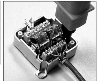
Según la referencia de IDC a la izquierda, use una herramienta de perforación 110 o Krone para engarzar y asegurar cada par de cables en su lugar en el producto. Ejemplos mostrados: Panel, por encima de l
