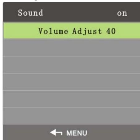
**Step 3** Ajuste el estado de encendido y apagado del sonido con los botones izquierdo y derecho del control remoto control.
