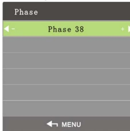
**Step 2** Ajuste la fase con los botones izquierdo y derecho del control remoto según sus necesidades.
