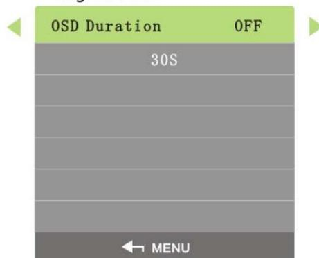
**Step 2** Configure la duración de OSD con los botones izquierdo y derecho del control remoto según sus necesidades.
