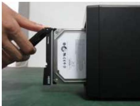
② Coloque el disco duro en la caja del disco duro en la parte delantera.
