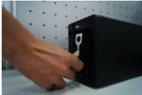
④ Vuelva a colocar la perilla después de insertar el disco duro a la placa SATA.
