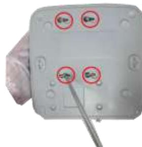
1. Afloje los tornillos de la parte inferior de el Sitio 2 el HDD en Dale la vuelta al dispositivo el chasis. de acuerdo con los cuatro orificios hacia abajo y luego asegure la parte inferior. tornillos firmemente.
