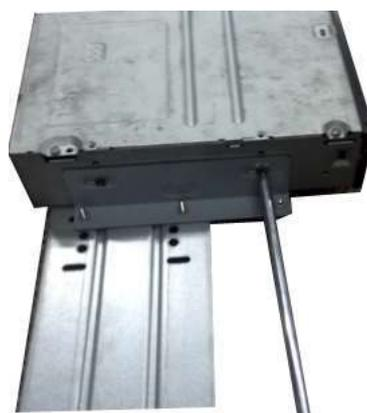
⑦ Destornillador de usuario para fijar los tornillos.
