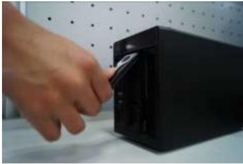
③ Tire de la perilla de HDD hacia arriba cuando coloque el HDD en la caja en caso de que la hebilla del pomo golpee el panel frontal.
