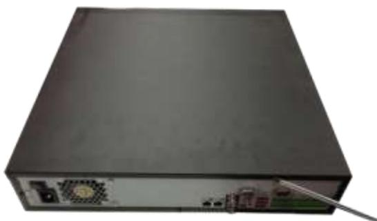
① ① Utilice el destornillador para aflojar los tornillos del panel trasero y luego retire la cubierta frontal.
