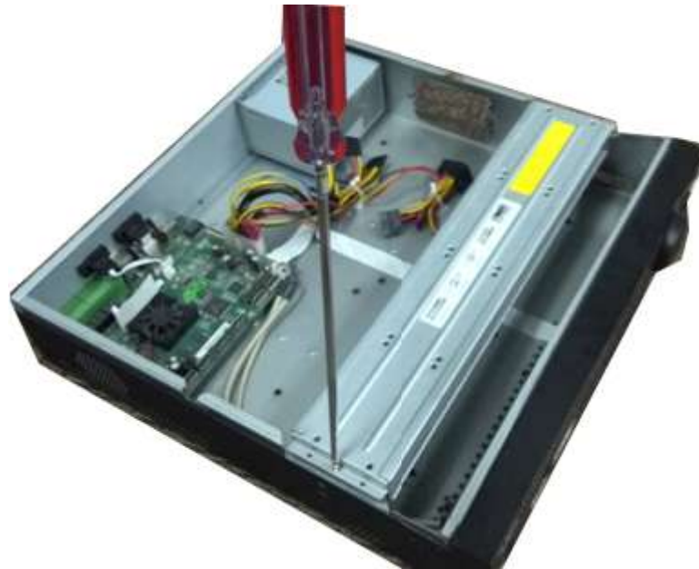
Figura 3-36 Abra la cubierta superior
