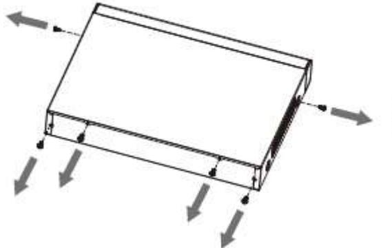
Paso 2 Retire la cubierta en la dirección de la flecha como se muestra en la siguiente figura.
