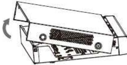
Paso 3 Dé la vuelta al dispositivo y alinee el disco duro con los cuatro orificios del panel inferior y luego fije el disco duro con tornillos.
