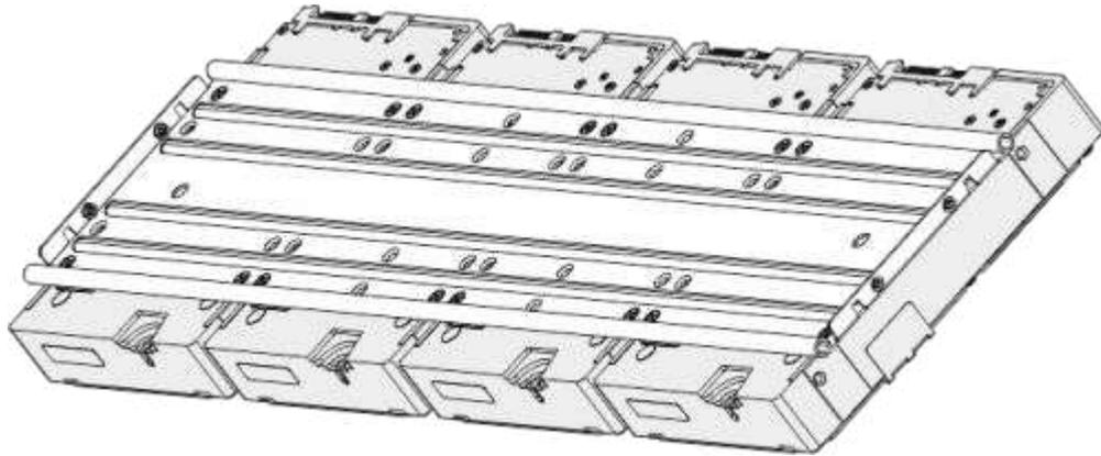
**Paso 6** Bloquee los dos soportes del disco duro.
