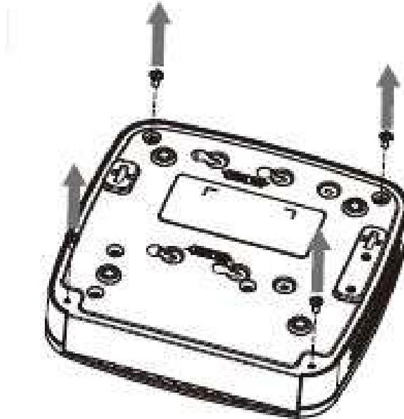
Paso 2 Coloque el HDD de acuerdo con los cuatro orificios en la parte inferior.
