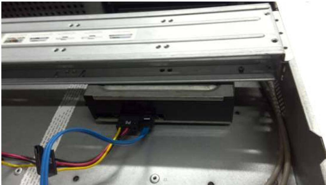
**Paso 9** Asegure el soporte del disco duro y vuelva a colocar la cubierta superior.
