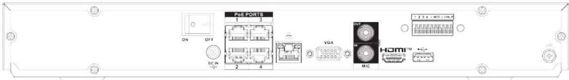
El panel trasero de la serie NVR42-8P-4KS2/NVR42-8P-4KS2/L/NVR42-8P-EI/NVR42-8P-4KS3 se muestra a continuación.
