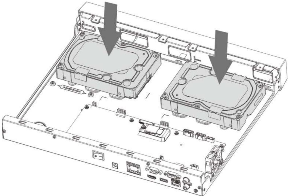
**Etapa 4** Voltee el dispositivo, haga coincidir los tornillos con los orificios del disco duro y luego fíjelos. El HDD está fijado al zócalo.
