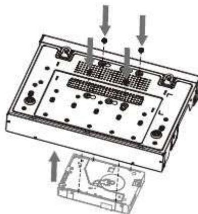
Etapa 4 Conecte el disco duro al dispositivo mediante el cable de datos y el cable de alimentación.
