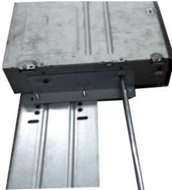
**Paso 7** Vuelva a colocar el soporte. Ajuste el CD-ROM a la posición adecuada de modo que el botón del panel frontal quede directamente frente al botón emergente del CD-ROM.
