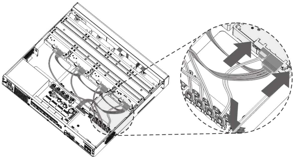
**Paso 9** Vuelva a colocar la cubierta y apriete los tornillos en el panel trasero para completar la instalación.
