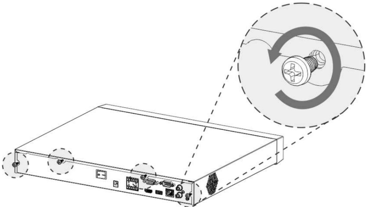
**Paso 2** Retire la cubierta de la caja en la dirección que se muestra en la siguiente flecha.
