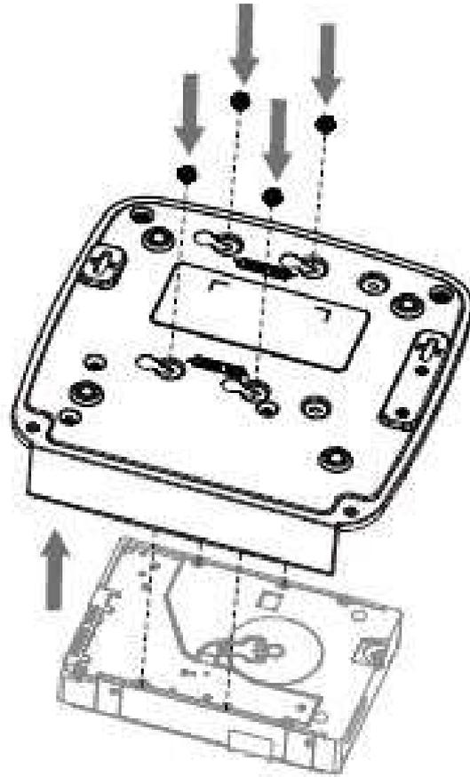
Etapa 4 Conecte el cable del HDD y el cable de alimentación al HDD y a la placa base respectivamente.
