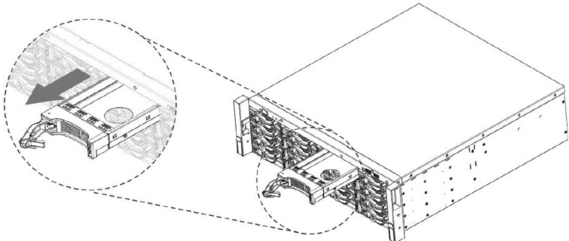
**Paso 2** Coloque el disco duro en la caja del disco duro en la dirección que se muestra en la siguiente flecha.
