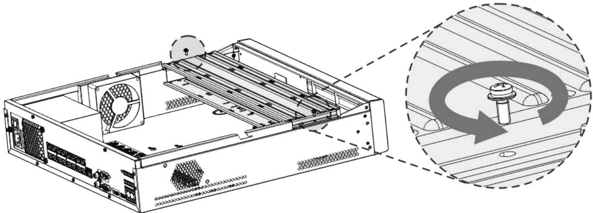
**Etapa 4** Haga coincidir los cuatro orificios para tornillos del disco duro con los cuatro orificios del soporte y luego ajuste los tornillos.
