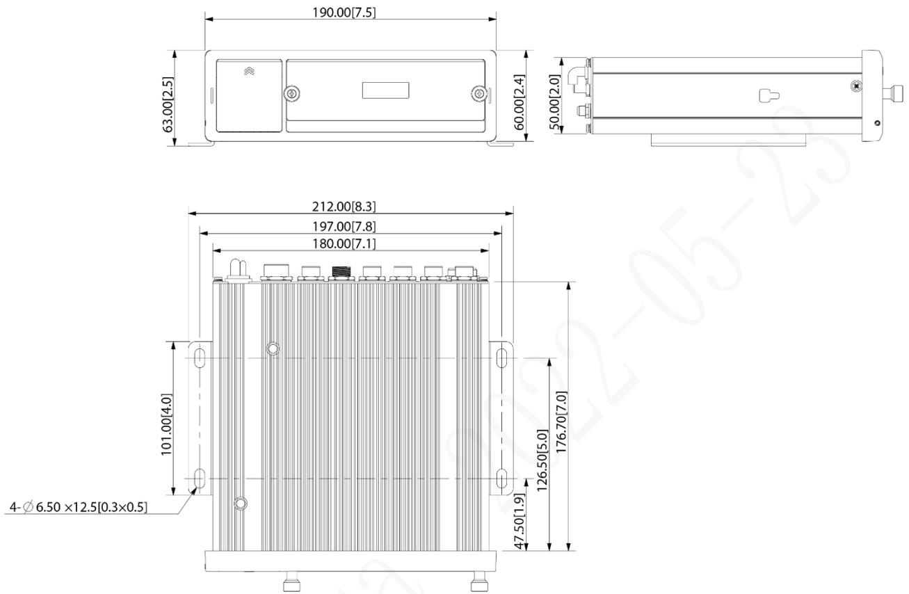
Figure 2-9 Dimensiones de instalación de orejetas (mm [pulgadas])
