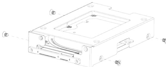
**Step 7** Instale la caja del portaunidades de disco duro en su lugar a lo largo de los rieles y luego fije el panel posterior de la caja de disco duro con dos tornillos.
