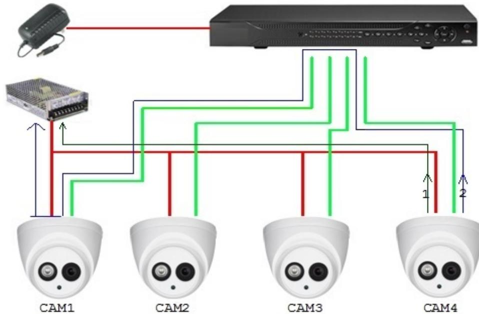
Hay dos rutas para la salida de energía de CAM4, la ruta de retorno 1 y la ruta de retorno 2. El reflujó 2 primero fluye hacia CAM1 y luego fluye hacia la fuente de alimentación desde la tierra de la fuente de alimentación de CAM1. De esta manera, el reflujó de la masa de la fuente de alimentación CAM4 afecta a la masa de vídeo de CAM1, lo que produce rayas de interferencia en la pantalla. Y CAM4 también interfiere con CAM2 y CAM3.
