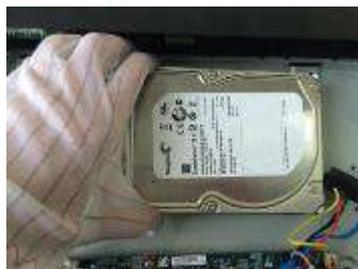
**Paso 5** Coloque el dispositivo boca abajo; Fije los tornillos para asegurar el HDD en la parte inferior del chasis.
