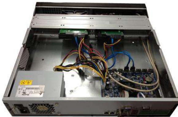
**Paso 4** Después de conectar el cable, vuelva a colocar la cubierta frontal en el dispositivo y luego fije los tornillos el panel trasero.
