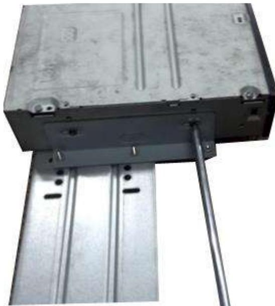
Paso 7 Vuelva a colocar el soporte. Ajuste el CD-ROM en la posición correcta para que el botón del panel frontal esté directamente frente al botón emergente del CD-ROM.
