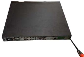
Paso 2 Coloque el disco duro de acuerdo con los cuatro orificios de la parte inferior.
