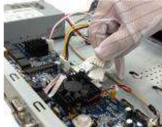
**Paso 3** Conecte el otro extremo del cable de datos del HDD y el cable de alimentación al HDD.
