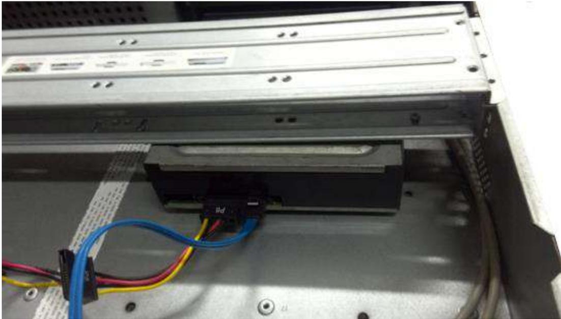
Paso 9 Asegure el soporte del HDD y vuelva a colocar la cubierta superior.
