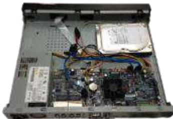
Paso 3 Coloque el dispositivo boca abajo y luego asegure los tornillos firmemente. Es para arreglar el disco duro en el chasis.
