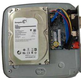
Paso 3 Coloque el dispositivo boca abajo y luego asegure los tornillos firmemente.
