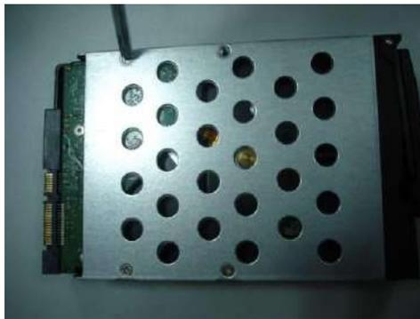
Paso 2 Coloque el disco duro en la caja del disco duro en la parte delantera.
