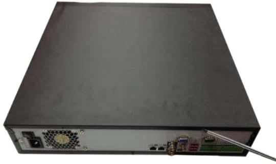
**Paso 2** Coloque el HDD en el soporte del HDD en el chasis y luego alinee los cuatro tornillos
