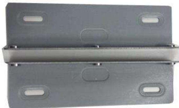
Paso 3 Fije el soporte del CD-ROM en el soporte del HDD.
