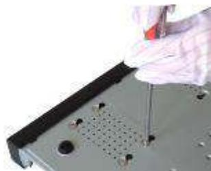
**Paso 6** Coloque la cubierta de acuerdo con el clip y luego fije los tornillos en el panel trasero y panel lateral.
