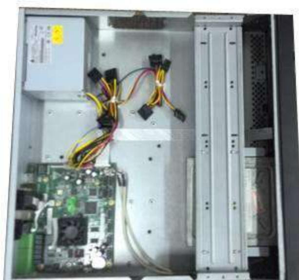
Paso 8 Conecte el cable SATA y el cable de alimentación.
