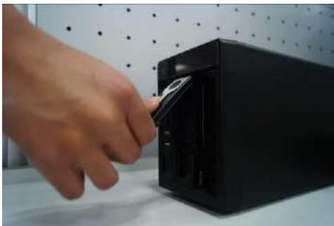
Paso 4 Vuelva a colocar la perilla después de insertar el disco duro en la placa SATA.
