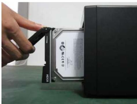
Paso 3 Tire de la perilla de HDD hacia arriba cuando coloque la HDD en la caja en caso de que la perilla se doble. puede golpear el panel frontal.
