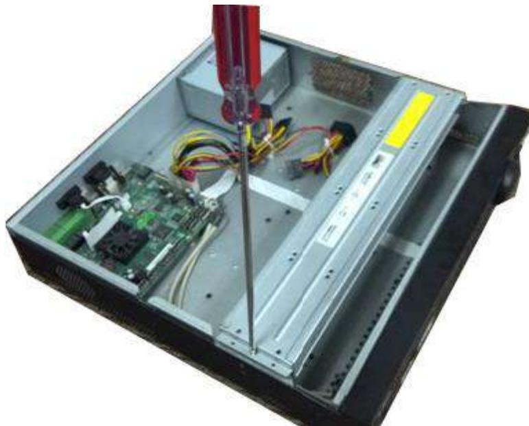
Paso 2 Quite la parte inferior del soporte del disco duro y del soporte del CD-ROM.
