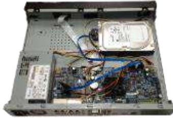
Paso 5 Coloque la tapa de acuerdo con el clip y luego fije los tornillos en el panel trasero y panel lateral.
