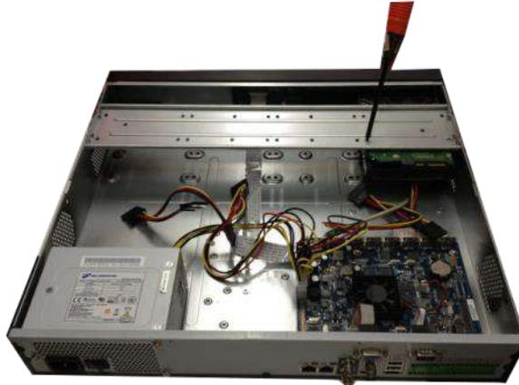
**Paso 3** Conecte el cable de datos HDD a la placa principal y al puerto HDD respectivamente.
