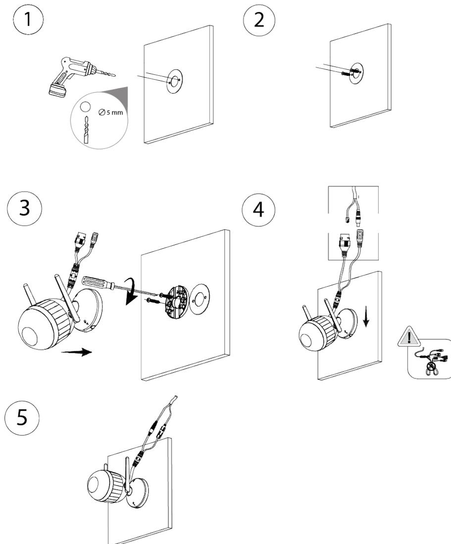
Figura 4-6 Cable que atraviesa la superficie de montaje
