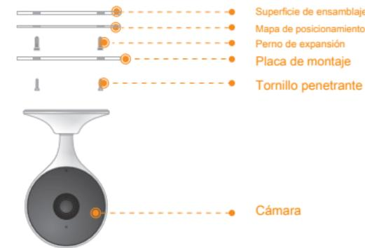
**Paso 1** Taladre agujeros para tornillos en la superficie de montaje como el mapa de montaje muestra, y luego coloque los pernos de expansión.
