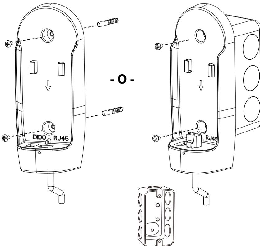
También puede colocar un soporte inclinable en la parte posterior del soporte de montaje.
