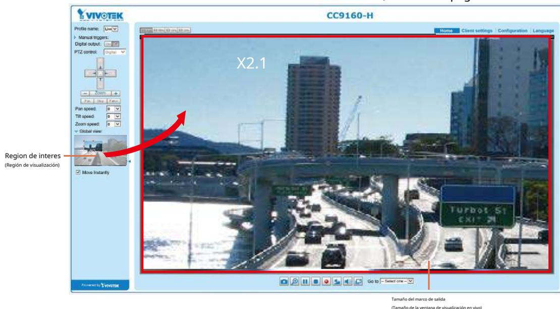
Haga clic en el elemento de la transmisión para mostrar la información detallada. El tamaño máximo del marco seguirá su configuración en las secciones anteriores de la Ventana de visualización.
