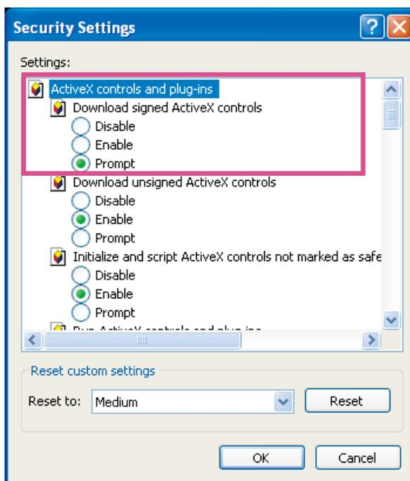
3 . Actualice su navegador web y luego instale ActiveX.®control. Siga las instrucciones para completar la instalación.
