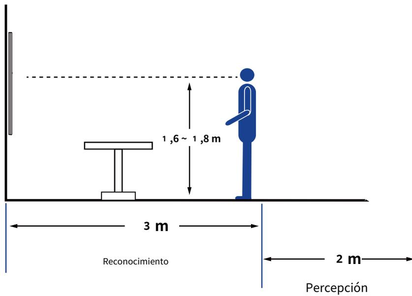
La cámara está diseñada para capturar actividades humanas en un campo de visión casi hemisférico, en un lugar como la entrada de una instalación comercial. Debido a las características ópticas de la lente gran angular, la calidad de la imagen disminuye a medida que aumenta la distancia a un objeto. Por lo tanto, se recomienda instalar la cámara a 3 metros o menos de los objetos de su interés. El centro de enfoque también debe estar alineado con objetos importantes, por ejemplo, rostros humanos.
