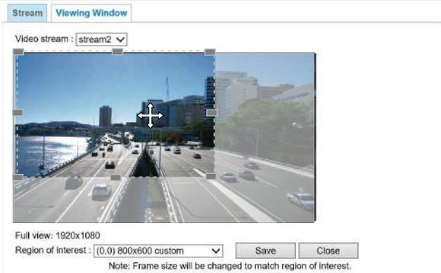
1. Siga los pasos a continuación para configurar esas configuraciones para una transmisión: 1. Seleccione una transmisión para la cual desea configurar la región de visualización.
