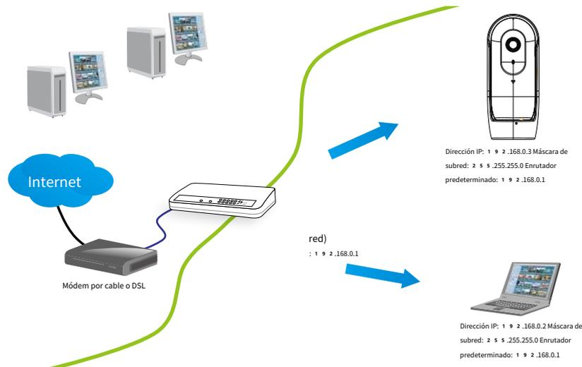
2. En este caso, si la dirección IP de la red de área local (LAN) de su cámara de red es 192.168.0.3, reenvíe los siguientes puertos para la cámara de red en el enrutador.
