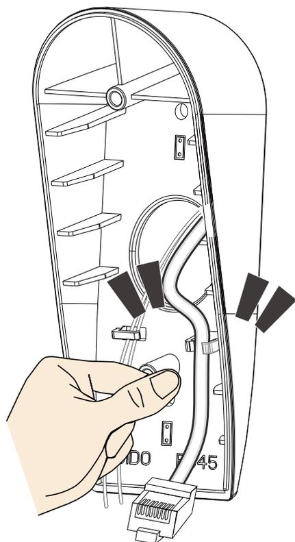
4 .Deslice la cámara de arriba a abajo contra el soporte. El conector RJ45 debe estar conectado.
