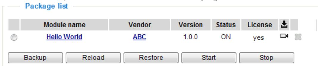
Si necesita eliminar un módulo, seleccione el círculo de verificación al frente y luego haga clic en **Detener** botón. Para entonces, el estado del módulo será **APAGADO**, y el **EL** botón aparecerá al final de la fila. Clickea en el **X** para eliminar un módulo existente.
