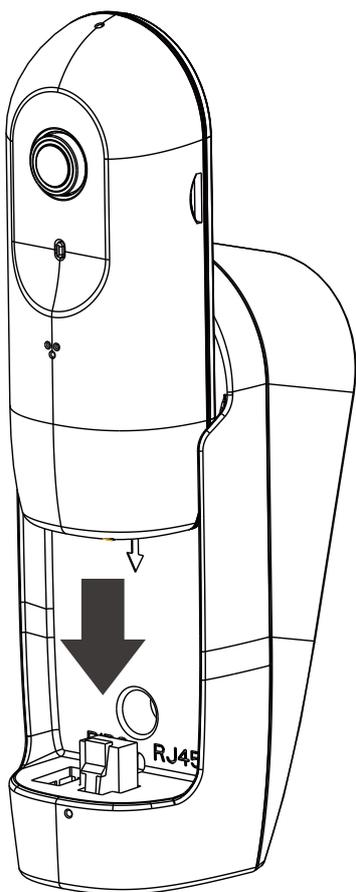
5 . Utilice la cubierta inferior que viene con adhesivo para sellar la parte inferior de su dispositivo.
