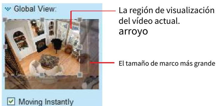
Tenga en cuenta que los botones PTZ del panel no funcionan a menos que muestre solo una parte de la imagen completa. Si la ventana de visualización en vivo muestra la vista completa, los botones PTZ no funcionan.
