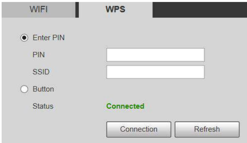
El PIN y el SSID se pueden obtener del enrutador. Ingrese el PIN y el SSID y luego haga clic en **Actualizar** para mostrar el estado de funcionamiento en tiempo real.
