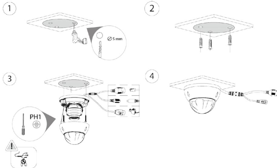
Figura 3-6 Cable que atraviesa la superficie de montaje
