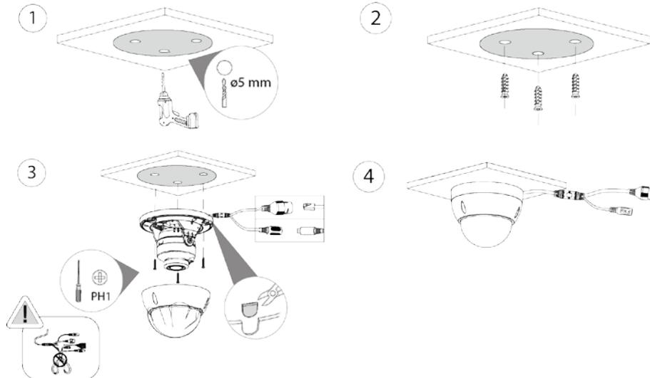
Figura 3-8 Cable que atraviesa la superficie de montaje
