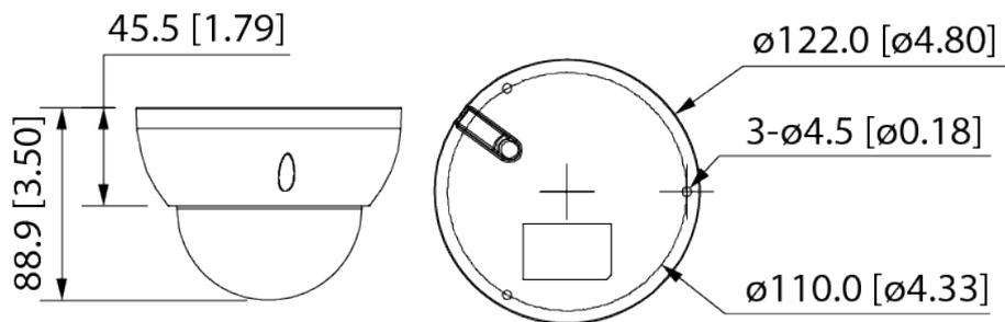
Figura 3-3 Dimensiones: Modelo B (mm [pulgadas])
