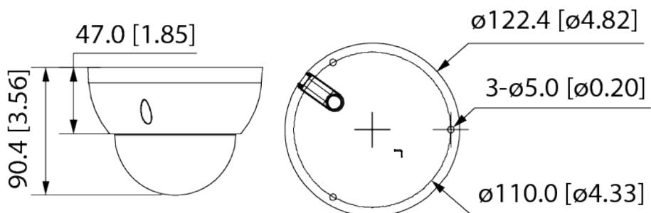
Figura 3-4 Dimensiones: Modelo C (mm [pulgadas])
