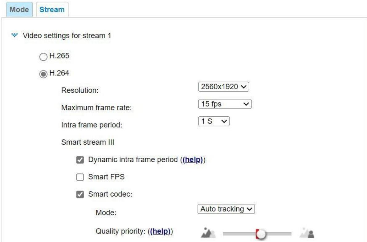
Esta cámara de red proporciona estándares de compresión H.265, H.264 y MJPEG (Triple Codec) en tiempo real para visualización en tiempo real. Si el **H.265** o **H.264** Cuando se selecciona el modo, el vídeo se transmite a través del protocolo RTSP. Hay varios parámetros a través de los cuales puedes ajustar el rendimiento del video:
