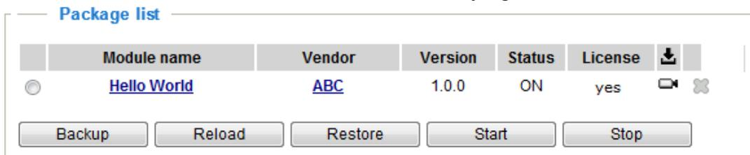
Si necesita eliminar un módulo, seleccione el círculo de verificación al frente y luego haga clic en **Detener** botón. Para entonces, el estado del módulo será **APAGADO**, y el **X** botón aparecerá al final de la fila. Clickea en el **X** para eliminar un módulo existente.
