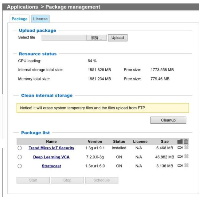
Los usuarios pueden almacenar y ejecutar módulos de software de VIVOTEK o de terceros en la memoria flash o tarjeta SD de la cámara. Estos módulos de software se pueden aplicar en análisis de video para aplicaciones de video inteligentes, como reconocimiento de matrículas, conteo de objetos o como agente para grabación de bordes, etc.
