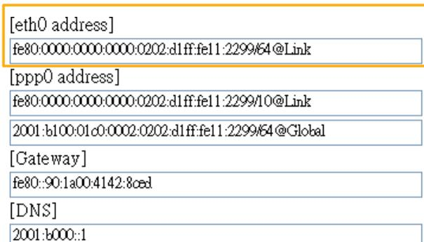
Configurar manualmente la dirección IP: seleccione esta opción para configurar manualmente la configuración de IPv6 si su entorno de red no tiene un servidor DHCPv6 ni enrutadores habilitados para anuncios de enrutador. Si marca este elemento, se mostrarán los siguientes espacios en blanco para que ingrese la información correspondiente:
