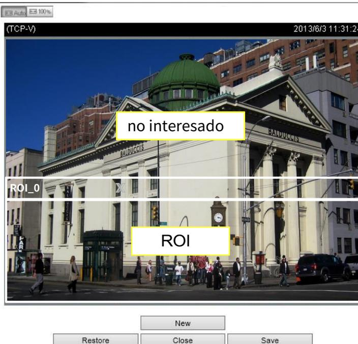
Como resultado, la pantalla inferior se muestra constantemente con gran detalle, mientras que la mitad superior se transmite utilizando un formato de menor calidad. Aunque la mitad superior se transmite utilizando un formato de menor calidad, aún tienes conocimiento de lo que sucede en toda la pantalla.
