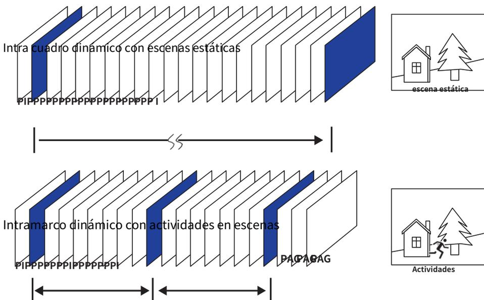
Con el códec H.265 en un escenario óptimo y cuando Dynamic Intra frame se combina con la función Smart Stream, se puede lograr un ahorro de ancho de banda del 80 % en comparación con el uso de H.264 sin habilitar estas funciones de ahorro de ancho de banda.
