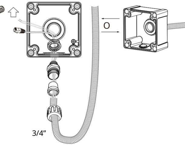
**2** Coloque la etiqueta de alineación incluida en la posición que prefiera. Taladre agujeros en la pared e instale la caja de conexiones. Si el espacio detrás de la pared lo permite, también puede pasar los cables a través de la pared.
