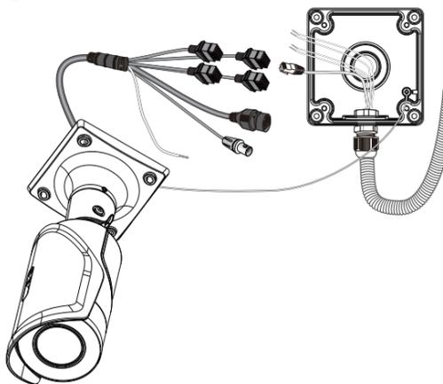
**6** Asegure la cámara a la caja con los tornillos de cabeza hexagonal.
