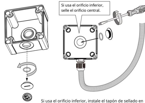
Si usa el orificio inferior, instale el tapón de sellado en el orificio no utilizado en el centro.
