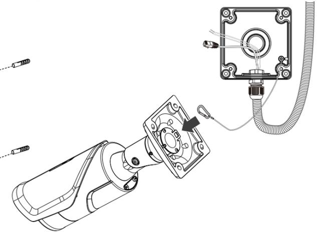
El dibujo toma IB9365 como ejemplo. Los cables combinados no se muestran aquí por razones de simplicidad.
