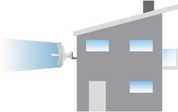
El LiteBeam montado en el exterior sin el reflector instalado proporciona cobertura solamente del exterior al interior a través del bocina de alimentación de 3 dBi.
