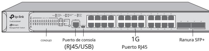
El panel frontal del TL-SG3428X-M2 se muestra en la siguiente figura.
