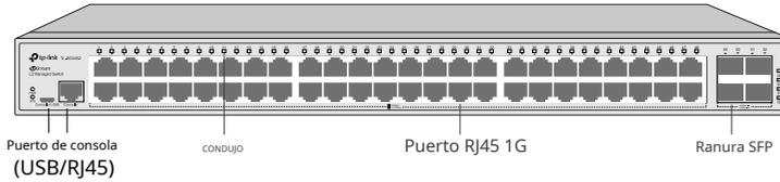
El panel frontal del TL-SG3452P se muestra en la siguiente figura.
