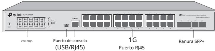
El panel frontal del TL-SG3428X-UPS se muestra en la siguiente figura.
