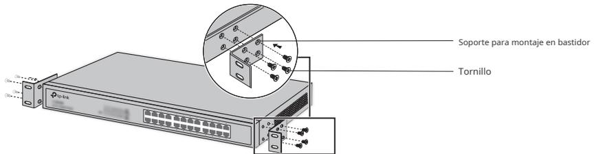
3. Después de fijar los soportes al dispositivo, utilice tornillos adecuados (no incluidos) para asegurar los soportes al rack, como se ilustra en la siguiente figura.
