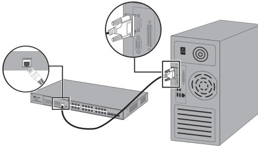
Conecte el puerto de consola (USB) del dispositivo a su computadora mediante el cable USB (no incluido) como se muestra en la siguiente figura.
