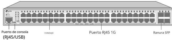
El panel frontal del TL-SG3452X se muestra en la siguiente figura.
