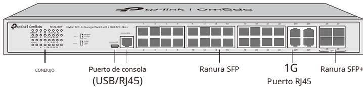
El panel frontal del SG3428XMP se muestra en la siguiente figura.
