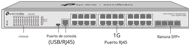
El panel frontal del SG3428XF se muestra en la siguiente figura.
