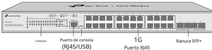
El panel frontal del SG3452XP se muestra en la siguiente figura.
