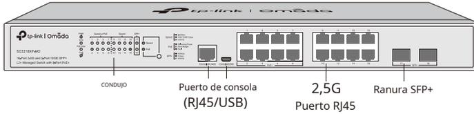
El panel frontal del SG3428 se muestra en la siguiente figura.
