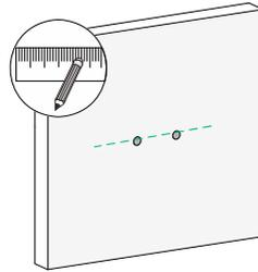
Marque los agujeros de instalación en la pared. Asegúrese de que los dos orificios de instalación estén en la misma línea horizontal.
