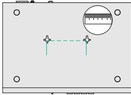
Mida la distancia entre los dos orificios de montaje en forma de cruz.
