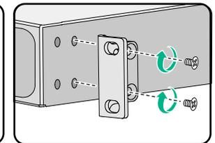
Coloque un soporte de montaje frontal tipo B cerca del lado de babor
