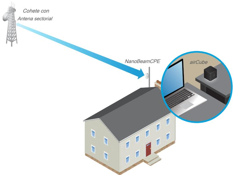
*Enlace punto a multipunto (PIMP): el airCube alimenta un CPE NanoBeam® 5AC Gen 2, que se conecta a un Rocket® Prism® 5AC Gen 2 en una antena sectorial airMAX ac.*
