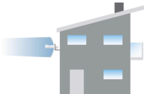
El PowerBeam montado en el exterior sin el reflector instalado proporciona cobertura solamente del exterior al interior a través del bocina de alimentación de 3 dBi.
