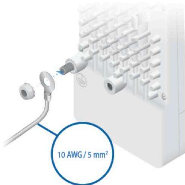
3. En el lugar de la instalación, asegure el otro extremo del cable de tierra a una toma de tierra, poste o barra de conexión de tierra.
