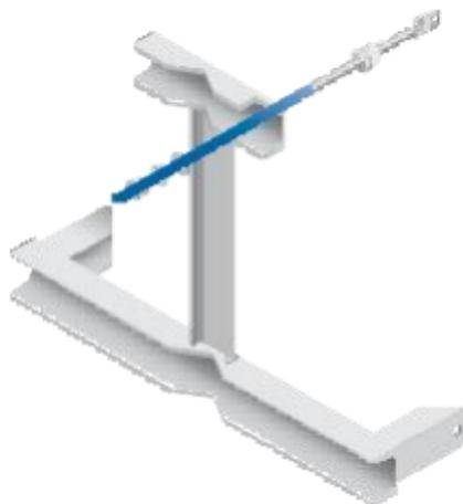
10. cada uno *Perno de carro M12x180* incluye una arandela plana, una arandela de seguridad con resorte y una tuerca. Qúitelos y utilícelos para asegurar los pernos cuando realice el montaje en el paso 16.
