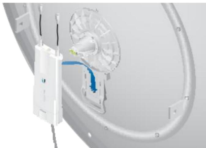
5. Fije el otro extremo de los *Cables RF* a los conectores RF en la radio airFiber en esta combinación:  $+45^\circ$  a *Cadena 0* y  $-45^\circ$  a *Cadena 1*. Luego deslice las fundas sobre los conectores RF para protegerlos.
