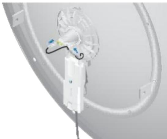
6. Conecte la antena GPS externa (incluida con la radio airFiber) al conector RF etiquetado *GPS* en la radio airFiber. Deslice la funda sobre el conector RF para protegerlo. A continuación, coloque la antena GPS externa magnética en el *Reflector de plato* (esto es temporal; montará la antena GPS externa en último lugar).
