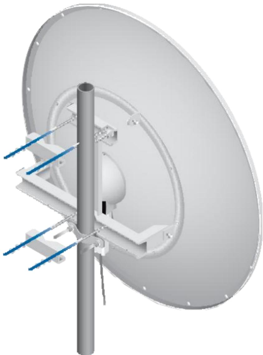
17. Alinee visualmente el acimut y la elevación.
