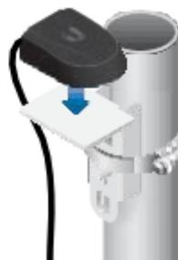
3. Asegure el cable de la antena GPS externa al soporte con una brida para cables
