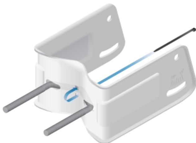
7. Asegure el *Soporte de montaje* la antena usando los cuatro *juego de pernos hexagonales con arandelas*.
