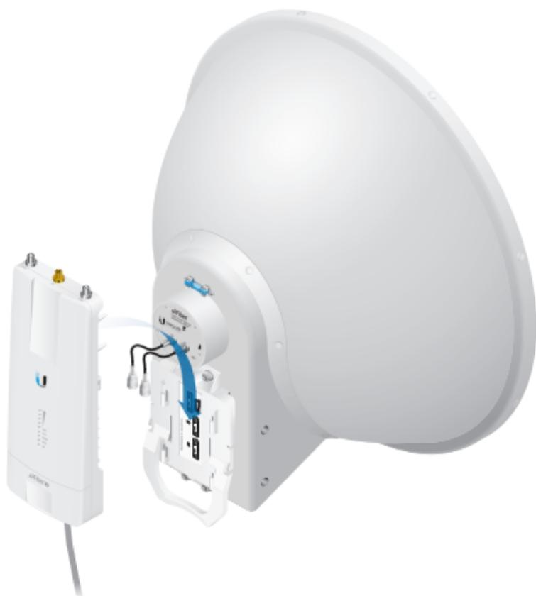
2. Conecte los conectores RF a la radio en esta combinación:
