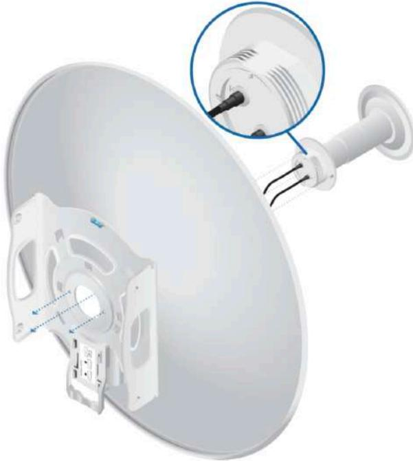
**!** **IMPORTANTE:** El reflector parabólico y el bocina de alimentación solamente se pueden instalar en una orientación.
