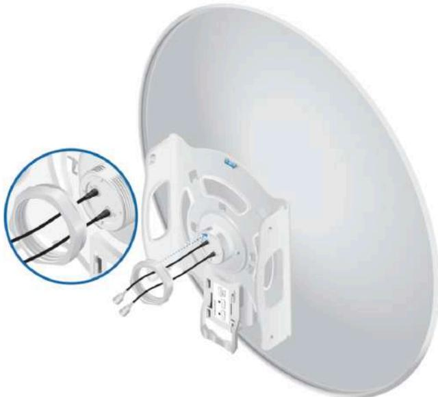
**📄** **Nota:** Apriete a mano hasta que la rosca toque la superficie del soporte de montaje. A continuación, utilice una llave o unos alicates de bloqueo de canal para apretar la rosca un cuarto de vuelta adicional. NO apriete demasiado la rosca.
