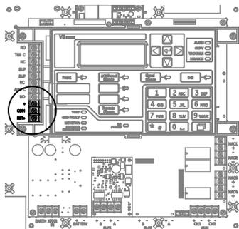
Figura 27: Terminales de salida de energía auxiliar/de detectores de humo
