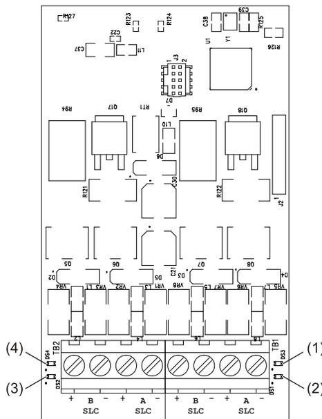
(1) LED DS3: Falla de SLC: Encendido fijo para indicar una falla por circuito abierto. Parpadea para indicar una falla por circuito en corto.
