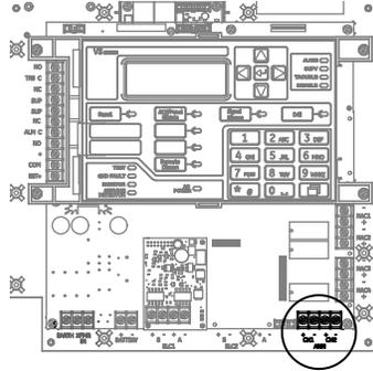
Figura 24: Cableado del canal del anunciador (Clase A)
