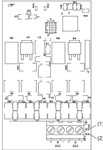
(1) LED DS3: Falla de SLC: Encendido fijo para indicar una falla por circuito abierto. Parpadea para indicar una falla por circuito en corto.
