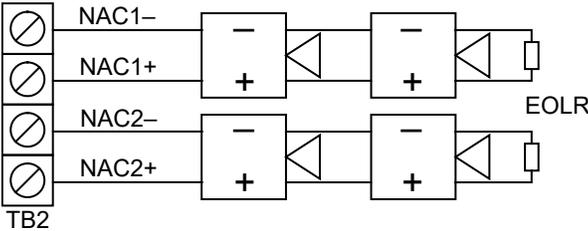
Figura 12: Cableado de NAC de Clase B en panel VS4
