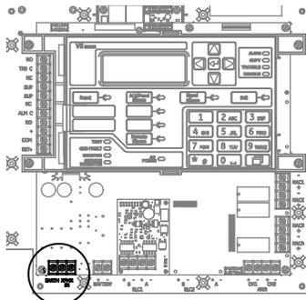
Figura 7: Cableado primario y secundario del transformador
