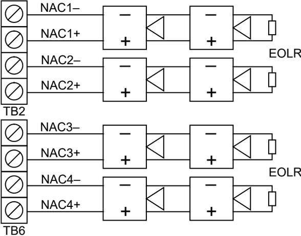
**Figura 13: Cableado de NAC de Clase A en panel VS4**
