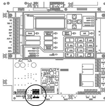
**Figura 9: Cableado de las baterías**
