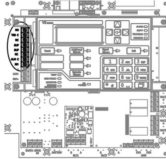
Figura 22: Terminales del cableado de relé
