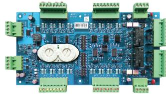
El módulo de interfaz de zona remota direccionable RZI16-2RS es un dispositivo direccionable que proporciona conexiones para dieciséis circuitos de dispositivos de iniciación de Clase B y dos circuitos de salida supervisados de Clase B. Las entradas y salidas se pueden configurar individualmente para varios tipos de dispositivos.
