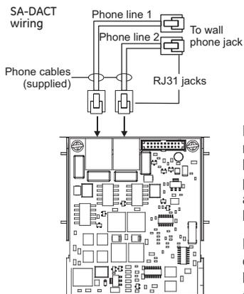
El SA-DACT pone en cola los mensajes y los transmite según la prioridad (alarma, supervisión, problemas y monitor). Las activaciones se transmiten antes de las restauraciones.
