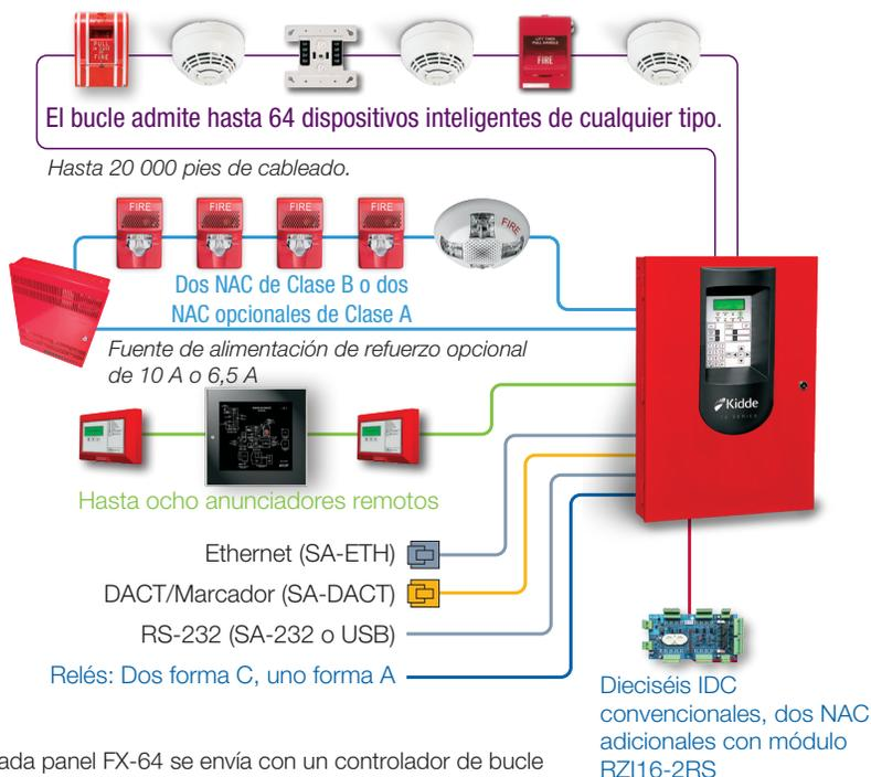
Cada panel FX-64 se envía con un controlador de bucle que admite 64 dispositivos de cualquier tipo. La capacidad del dispositivo de este panel no se puede expandir.
