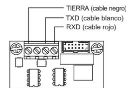
La tarjeta RS-232 está instalada en el conjunto de plástico y se conecta a la placa de circuitos principal a través de un cable plano.
