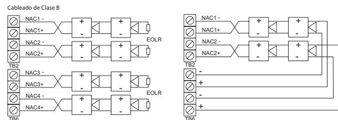
La marca indica la polaridad de la señal de salida cuando el circuito está activo. La polaridad se invierte cuando el circuito no está activo. Conecte los dispositivos de notificación según corresponda. La polaridad del dispositivo de notificación que se muestra corresponde a su estado activo.
