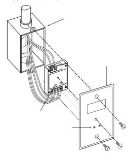
GSA-MCR y GSA-MCRR: monte la placa base UIO dentro de un gabinete Edwards adecuado con los tornillos y arandelas proporcionados.
